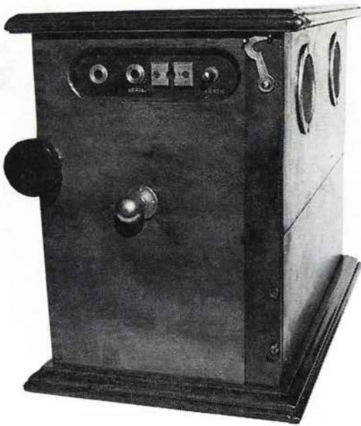
figura 9 - Foto del ricevitore ripreso di lato per mostrare la manopola del variatore di sintonia (in bachelite nera), quella del reostato (a sfera metallica) e le prese di antenna e terra.
