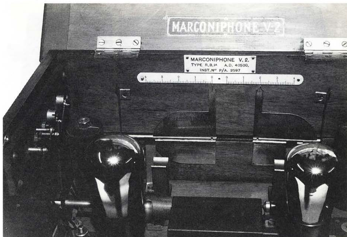
figura 3 - Vista interna del ricevitore con i blocchi di gamma asportati. Sul fondo sono ben visibili le lamine di sintonia con la scala graduata. Sul davanti si notano le due valvole e tra loro il trasformatore di accoppiamento BF (T).
