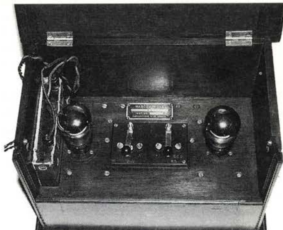
figura 12 - Interno dell'amplificatore A2. Si nota la batteria e il cordone bifilare con spina a passo differenziato per il collegamento al ricevitore V2.
