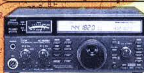
IC 820HF - VHF/UHF ultracompatto - SSB/CW/FM - 45W - PLL - 13,8 Vcc - DDS risoluzione 1 Hz
