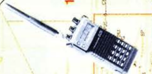
IC-R1 - Ricevitore di ridottissime dimensioni per ricezione da 100KHz a 1300 MHz
